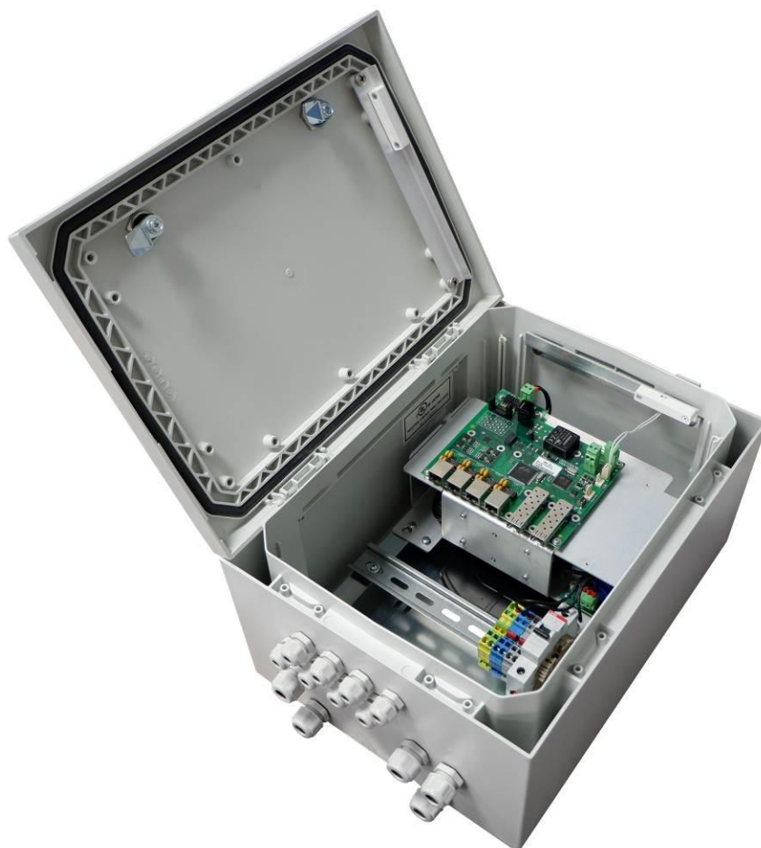
Рисунок 3.1.2 - PSW-2G+Box - вид внутри
