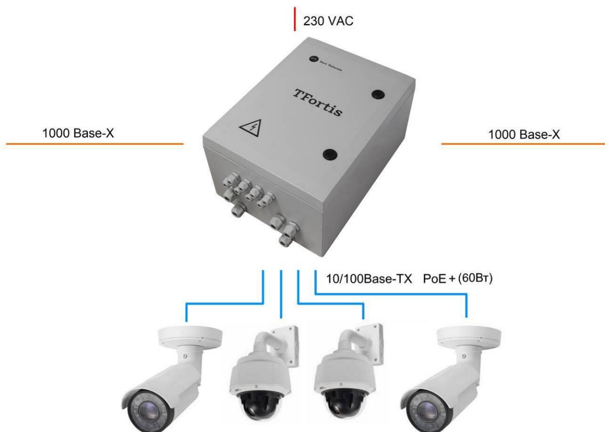
Рисунок 1 - Схема подключения PSW-2G+Box
